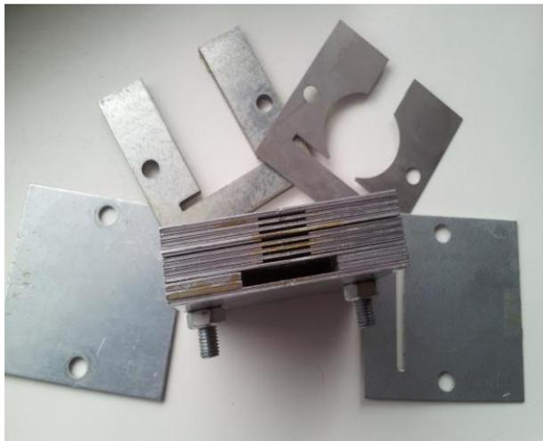
Fig. 3. Epoxy casting mold
